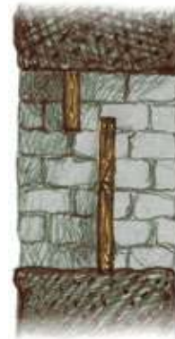
Abb. 26: Einflugmöglichkeit für Fledermäuse unter Ausschluss von Tauben
