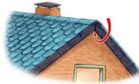
Abb. 18: Einflugmöglichkeit in das Unterdach über offenen Dachüberstand
