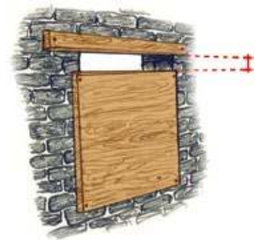
Abb. 27: Einflugschlitze müssen kleiner als 5 cm sein
