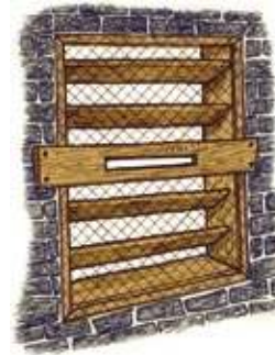
Abb. 26: Einflugmöglichkeit für Fledermäuse unter Ausschluss von Tauben
