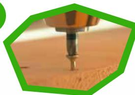
Löcher für die Schrauben laut Anleitung vorbohren, danach die Einzelteile zusammenschrauben.
